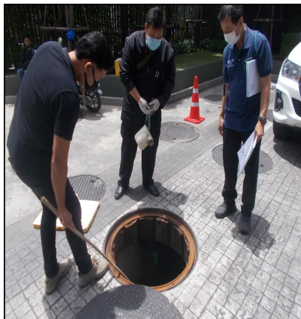
ภาพที่ 5.1.1 การเก็บตัวอย่างน้ำเสีย ก่อนเข้าระบบ
