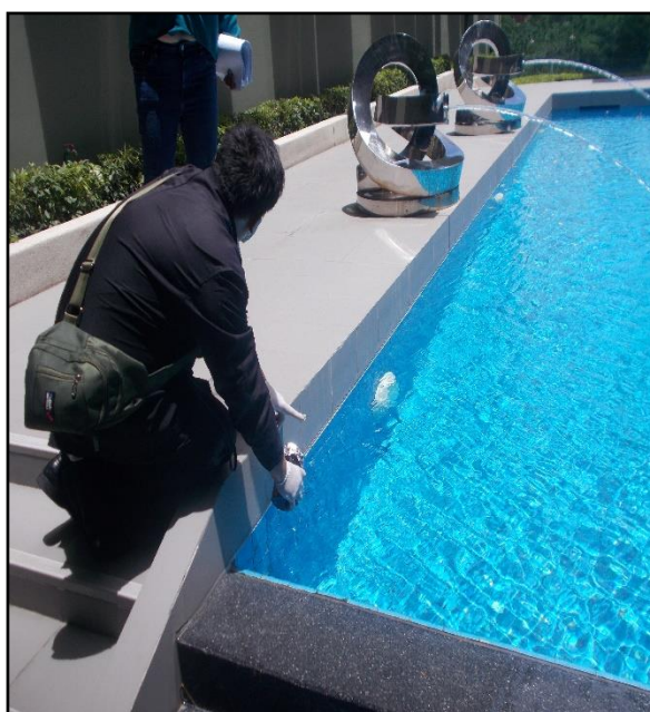
ภาพที่ 5.2.1 การเก็บตัวอย่างน้ำ สระว่ายน้ำ จุดเก็บความลึกระดับ ผิวน้ำ
