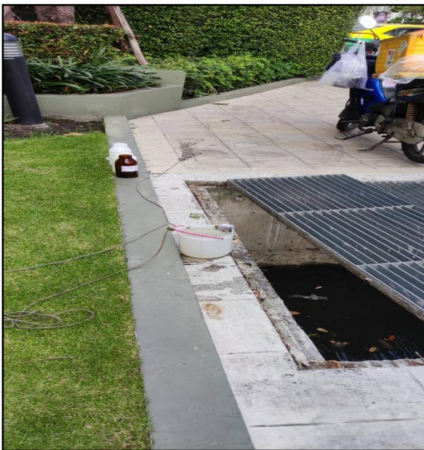
ภาพที่ 5.1.2 การเก็บตัวอย่างน้ำทิ้ง บ่อพักน้ำสุดท้าย
