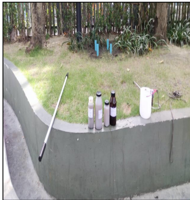
ภาพที่ 5.1.2 การเก็บตัวอย่างน้ำทิ้ง บ่อพักน้ำสุดท้าย
