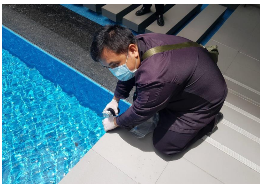
ภาพที่ 5.2.1 การเก็บตัวอย่างน้ำ สระว่ายน้ำ จุดเก็บความลึกระดับ ผิวน้ำ
