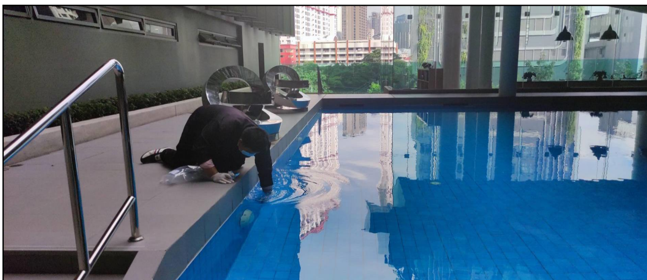
ภาพที่ 5.2.2 การเก็บตัวอย่างน้ำ สระว่ายน้ำ จุดเก็บความลึกระดับ กึ่งกลางสระ
