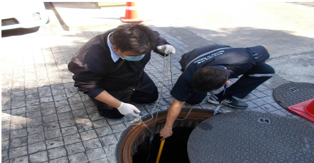
ภาพที่ 5.1.1 การเก็บตัวอย่างน้ำเสีย ก่อนเข้าระบบ
