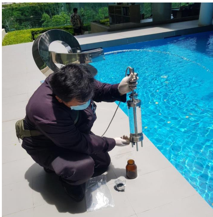
ภาพที่ 5.2.2 การเก็บตัวอย่างน้ำ สระว่ายน้ำ จุดเก็บความลึกระดับ กึ่งกลางสระ
