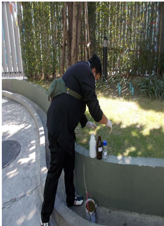
ภาพที่ 5.1.2 การเก็บตัวอย่างน้ำทิ้ง บ่อพักน้ำสุดท้าย
